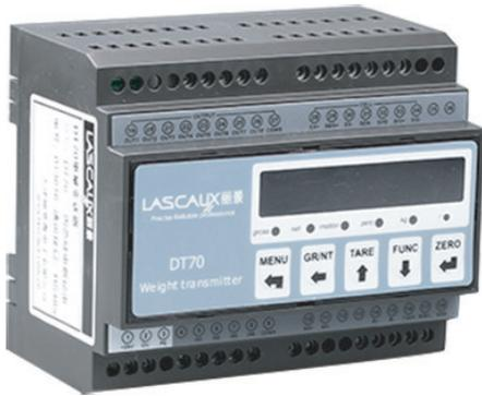
DT70 应变传感器数字变送控制器，是一种多用途重量信号转换设备，集显示、变送和控制于一体，具有串行数字信号输出，模拟信号输出等多种功能；采用导轨安装方式，体积小、重量轻；DT70 经过严格的电磁兼容性测试，性能可靠。适用于各种拉力、压力、张力测量、称重式料位，料斗秤、天车秤、吊秤、拉压力试验机等电阻应变式称重传感器的应用场合。同时能满足模拟称量传感器的数字化升级，在粮食、轻工、冶金、建材、化工、有色、能源、机械等各行业工业过程称重与测力上广泛应用。
